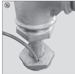
⑯ Heberschutzschlauch der Elektropumpe durch die Entnahmeleitung der Grundeinheit in den 1. Tank einführen.
