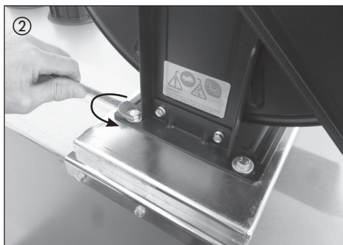
② Monter l'enrouleur de tuyau sur la console avec : 4 vis hexagonales M 8x16 4 rondelles A8, 4
