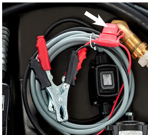
Fusible plat sur la borne +
