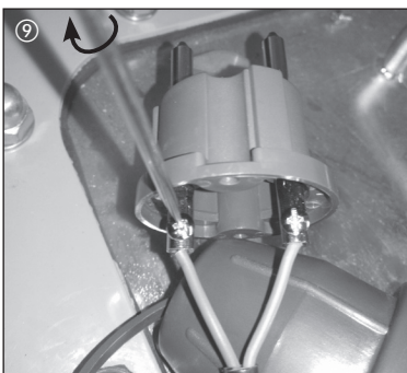
⑨ Leitungen am Stecker der Anschlussdose gemäß Kennzeichnung anschließen. Braun = Pluspol (+), Blau = Minuspol (-)
