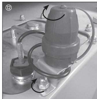
⑫ Verschlusskappe zuschrauben. Bügel auf dem Stahlinnentank montieren.
