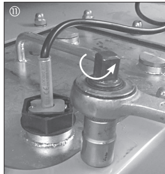
⑪ Eine Sechskantmutter am Stahlinnentank lösen und die darunterliegende Scheibe mit entfernen.
