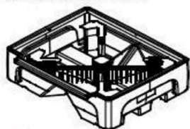
Typ 10 (Erweiterungsauffangwanne mit Stützkreuz 500 l)
