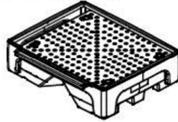
Typ 12 (Erweiterungsauffangwanne mit Stützkreuz und PE-Lochplatte, 500 l)
