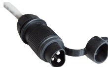
10229 - Stecker DIN 9680, 3-polig 6 - 24 VDC, max. 25 A, IP 54
