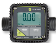
10450 - Digitaler Zähler FMT 3 PP, 5 - 120 l/min beidseitig 1" AG
