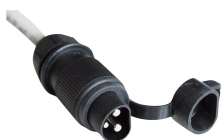
10229 - Stecker DIN 9680, 3-polig 6 - 24 VDC, max. 25 A, IP 54
