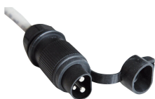
10229 - Stecker DIN 9680, 3-polig 6 - 24 VDC, max. 25 A, IP 54
