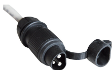
10229 - Stecker DIN 9680, 3-polig 6 - 24 VDC, max. 25 A, IP 54
