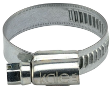
7030 - Schlauchschele 20-32 / 9 mm Kreuzschlitzschraube, verzinkt
