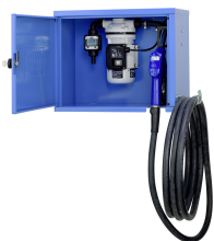
10058 - Pumpenschränk kpl., ca. 30l/min K24, 4 m Zapfschlauch, AZV
