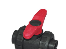
6426 - PVC- Kugelhahnen beids. R1" i Dichtung EPDM
