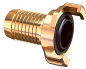
10765 - Geka-Kupplung mit 3/4" Schlauchtülle Messing, Dichtung NBR, oh. KTW-Zulassung
