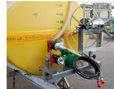
10541 - ZentPumpHydrMot FMC150 vollst. Armaturen u. Füll-/ Sauganschl.
