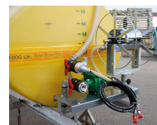
10542 - Schlauchhaspel verzinkt, schwenkbar hoch / nieder, vollst., für BWS 500
