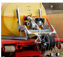
10543 - Schlauchhaspel klappbar kpl. Anschluss C-Kupplung und Geka 1"
