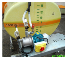
10861 - E-Motorpumpe 1" IG bis 60 l/min 24 V / 19 A / DC, mit Druckschalter
