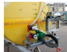
10542 - Schlauchhaspel verzinkt, schwenkbar hoch / nieder, vollst., für BWS 500
